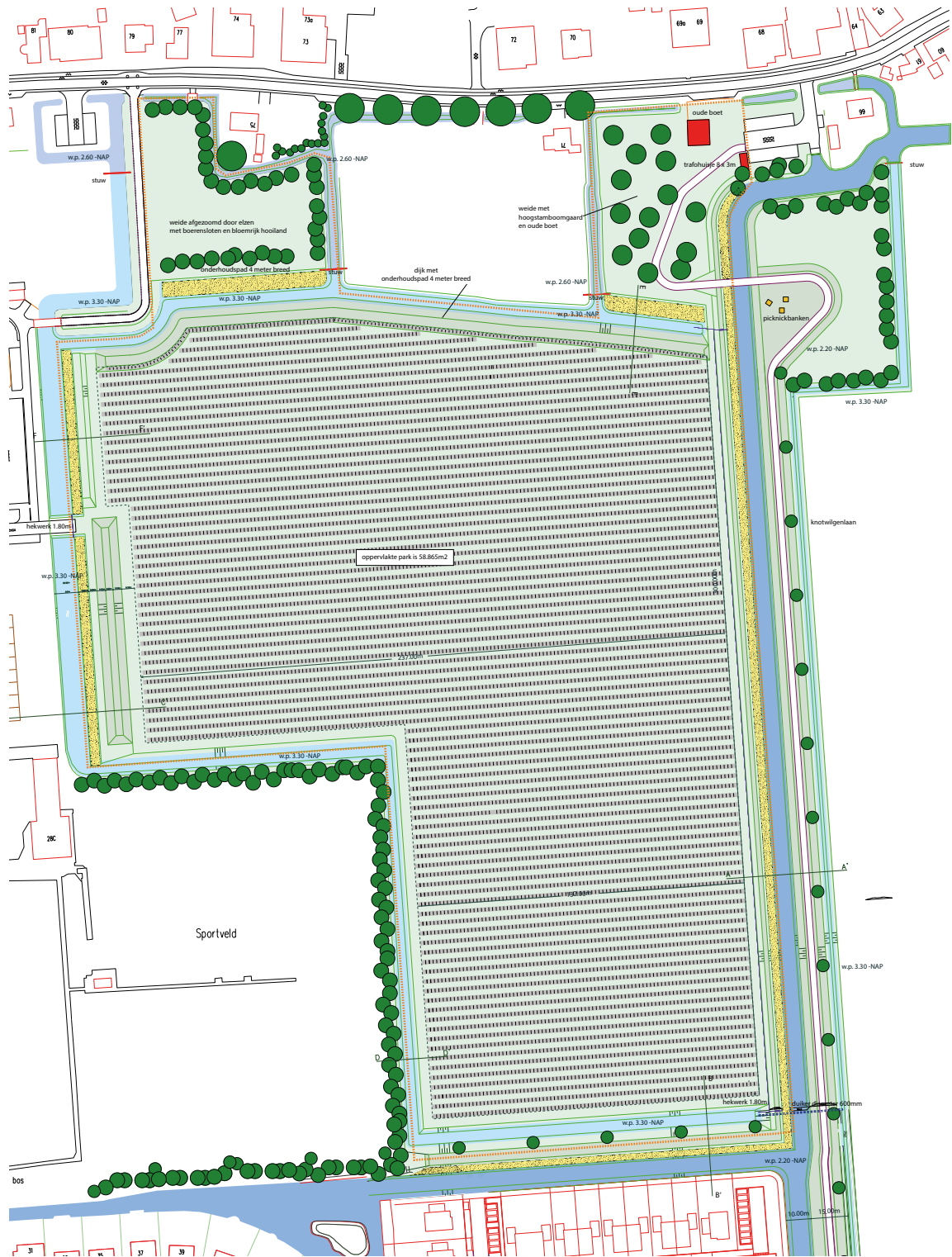
EXTRA WATER MET NATUURVRIENDELIJKE OEVERS, ECOLOGISCH BEHEER VAN HET GRAS TUSSEN DE ZONNEPANELEN.
